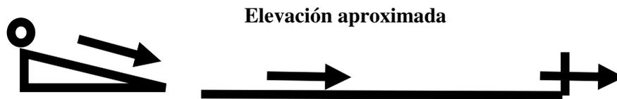
Rampa metálica L=1.20m Superficie plana de rodadura 3.00 m Arco
