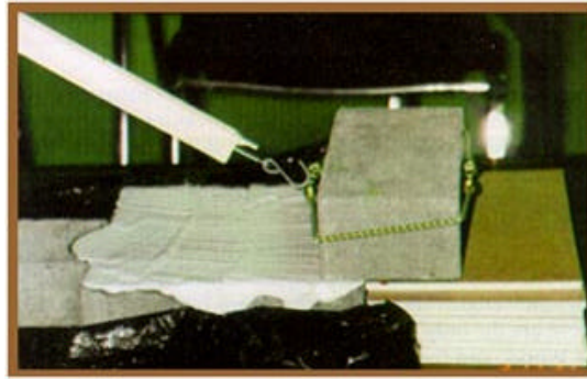
Fig 1 -- Un simple experimento que muestra que la fricción entre bloques de hormigón se reduce en más de 50% si se usa mortero de yeso.
